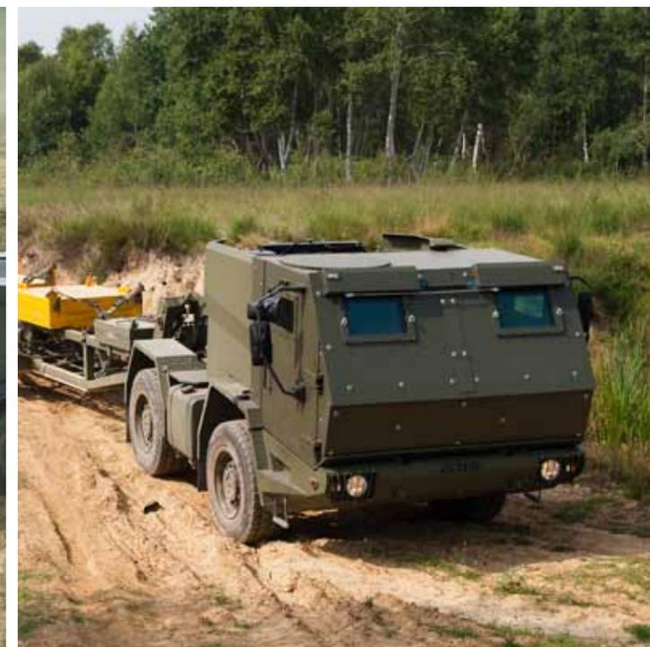
Sistema di trasporto tipo "Low/Flat Bed" per Caricamento e Scaricamento su Velivoli C130J (Airlift Global Carrier)
